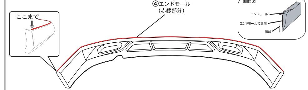
⑤塗装行程を行なった後、エンドモールと両面テープの取付け面を十分脱脂します。
