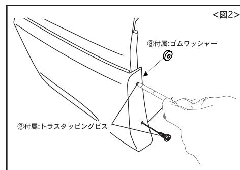
③バンパーホイールハウス部に、R/Hの取付け穴位置をしっかりと決め、リアバンパーに穴位置をマーキング後バンパーにキリ等で穴開けを行い、付属のトラススタッピングビスで締め込みながら仮止めします。また、上部のみはバンパーとspoilerの間に付属のゴムワッシャーを入れて、取付けて下さい。<図2参考>
